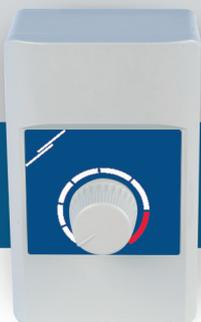
El USP-X10K-NA es un potenciómetro pasivo, diseñado para reguladores, que exigen una tensión de entrada 0–10 VDC. La tensión de salida se puede ajustar de una manera progresiva de 0 a la tensión de salida (Us) a través de un botón giratorio (knob). El dispositivo dispone de un interruptor, (contacto seco), que permite una conmutación ON / OFF remota de equipos externos.
