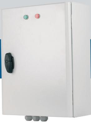
Las series STVS4 incluyen reguladores por transformadores, que regulan la velocidad de motores trifásicos, regulables por tensión. La regulación se realiza de una manera gradual (en 5 escalones) según una señal de control 0-10 VDC. Los reguladores STVS4 tienen autotransformador(es) y también disponen de una monitorización TK para protección térmica del motor.
