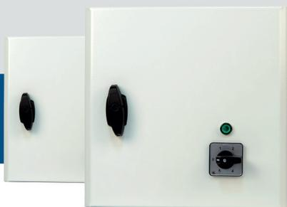
Las series STRS4 incluyen reguladores de la velocidad de rotación de ventiladores con motores trifásicos, regulables por tensión, a través de la variación de la tensión de salida. Estos dispositivos son equipados con autotransformadores y regulan la velocidad manualmente en cinco escalones (posiciones). Los STRS4 disponen de monitorización TK para protección térmica del motor. Los reguladores de las series STRS4 ofrecen una tensión de salida regulada con una forma sinusoidal perfecta.
