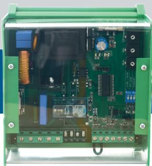
Las series MVS incluyen reguladores, que controlan la velocidad de motores monofásicos, regulables por tensión (230 VAC / 50–60 Hz) a través de una entrada (0–10 VDC / 0–20 mA) o a través de la comunicación Modbus RTU. Estos dispositivos tienen una gran variedad de funcionalidades: opciones de control remoto, nivel de apagado (OFF) regulable, ajustes de tensión de salida mín. y máx., así como posibilidad de limitar el tiempo de funcionamiento del motor a través de una señal lógica o interruptor.
