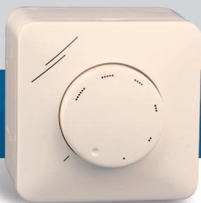
El potenciómetro MTV-1-010-NA ofrece una regulación de equipos, que se necesitan de una señal de control de 0 a 10 VDC. Este dispositivo requiere una tensión de alimentación de 230 VAC y produce una señal de salida progresiva de 0 a 10 VDC. El potenciómetro destaca con su alto grado de protección (PI) y es adecuado tanto para montaje empotrado (IP44), como para montaje en superficie (IP54).
