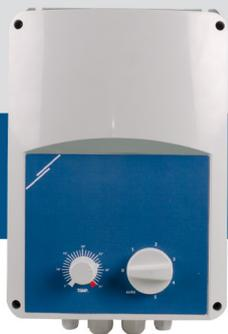
Las series GTH incluyen reguladores de velocidad de rotación de motores monofásicos, regulables por tensión, que cambian la tensión de salida según la temperatura medida. Estos dispositivos tienen autotransformadores y regulan la velocidad de ventiladores en modo automático o manual (en 5 escalones), según la señal de entrada generada por un sensor de temperatura. La salida no regulada también permite un control según la temperatura, (por ejemplo control de una válvula de agua caliente).
