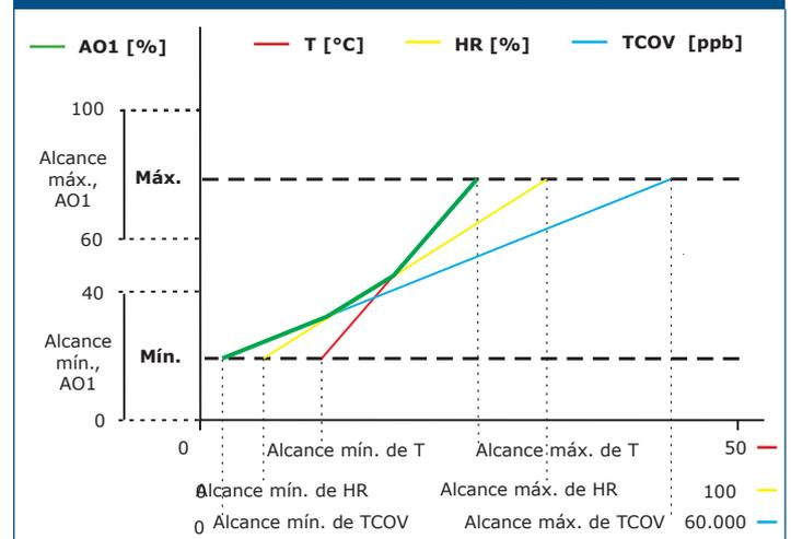
**NOTA:** Las mediciones de TCOV permanecerán en 0 ppb durante el tiempo de precalentamiento. La salida se cambiará automáticamente, dependiendo del valor más alto de TCOV, T o HR. Esto es, el valor más alto de los tres controlará la salida. Véase la línea verde del 'Diagrama de funcionamiento'. Se pueden desactivar una o varias mediciones. Por ejemplo, es posible controlar la salida solamente en función de las mediciones de TCOV.
