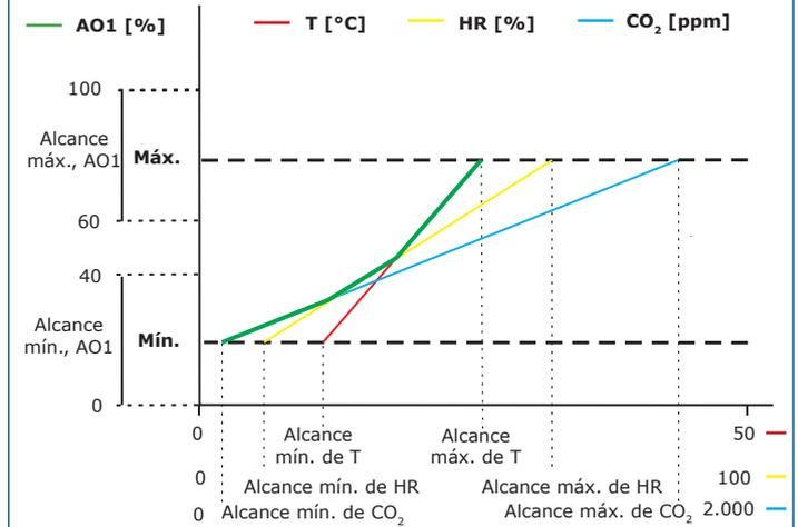
**NOTA:** La salida cambia automáticamente, dependiendo de los valores más altos de CO<sub>2</sub>, T y HR, es decir, el más alto de los tres valores de salida efectuará su control. Véase la línea verde del 'Diagrama de funcionamiento'. Se pueden desactivar una o varias mediciones. Por ejemplo es posible controlar la salida solamente en función de las mediciones de CO<sub>2</sub>.
