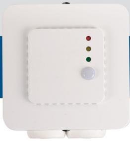
Las series FCMF8-R incluyen sensores inteligentes con alcances ajustables de temperatura (T), humedad relativa (HR) y dióxido de carbono (CO<sub>2</sub>). Su algoritmo controla una salida analógica / con señal de modulación en función de las mediciones de CO<sub>2</sub>, T y HR, que se puede usar para control directo de ventiladores EC, reguladores de velocidad de ventiladores AC y actuadores para válvulas o compuertas. Todos los parámetros son accesibles a través de la comunicación Modbus RTU.
