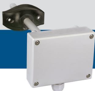
Las series DSVCX-R incluyen transmisores multifuncionales para conductos, que miden temperatura, humedad relativa y una amplia gama de compuestos orgánicos volátiles (COV). La concentración de TCOV constituye un indicador preciso de la calidad del aire interior. Estos sensores tienen 3 salidas analógicas / con señal de modulación para: temperatura, humedad relativa y TCOV. Todos los parámetros y mediciones son accesibles a través de la comunicación Modbus RTU.
