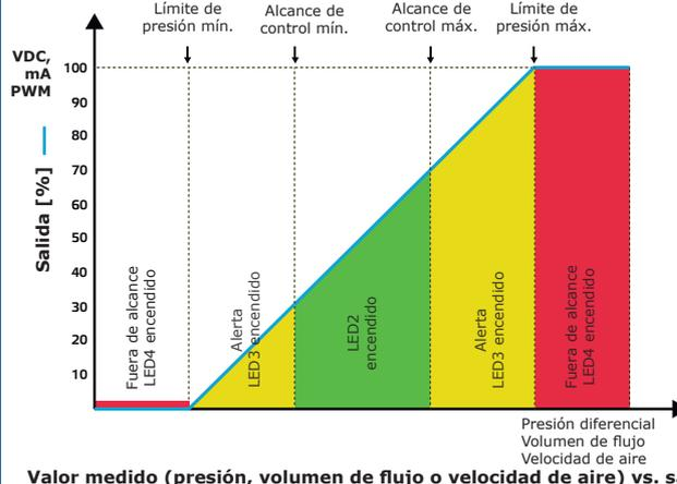
Valor medido (presión, volumen de flujo o velocidad de aire) vs. salida
