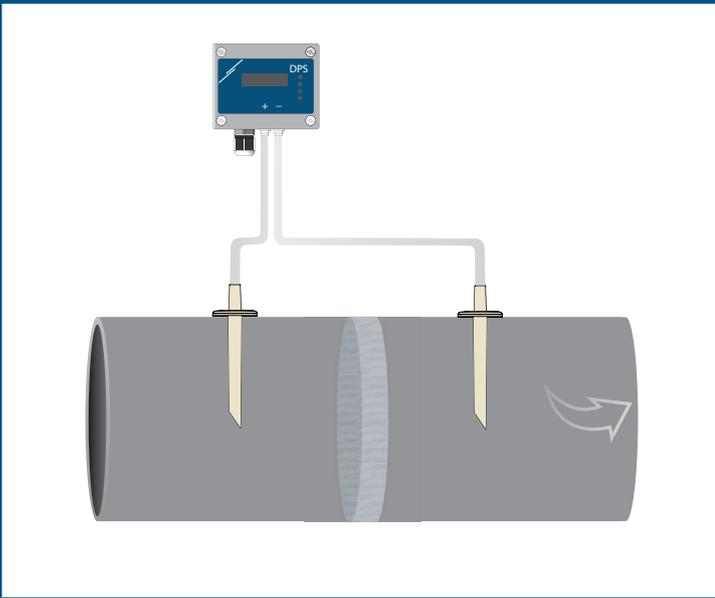
**Aplicación 2:** Medición del volumen de aire suministrado \ [m<sup>3</sup>/h] o la velocidad del flujo de aire \ [m/s], usando PSET-PVC
