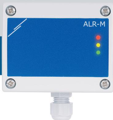
El ALR -M1 es un dispositivo de alarma acústica y visual, creado para generar alertas en casos de averías. Se precisa el uso de otro dispositivo principal (master), como el controlador RDPU de Sentera con interfaz HMI o el uso de un sistema de gestión de edificios, que pueda introducir valores en los Modbus holding registers. La alimentación del ALR -M1 es Power over Modbus y todos los parámetros también son accesibles a través de dicha comunicación.
