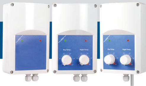
Las series AH2X1-6 incluyen reguladores para elementos de calefacción monofásicos o bifásicos. Estos dispositivos utilizan un control proporcional de tiempo variable: la relación entre el modo de encendido y apagado se puede modificar en dependencia con la temperatura deseada. La corriente se regula por un 'triac', que minimiza el desgaste, así como garantiza un control preciso, reduciendo los costos de energía.
