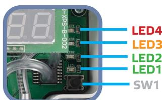
**Fig. 9 Calibration & Modbus reset indication**
