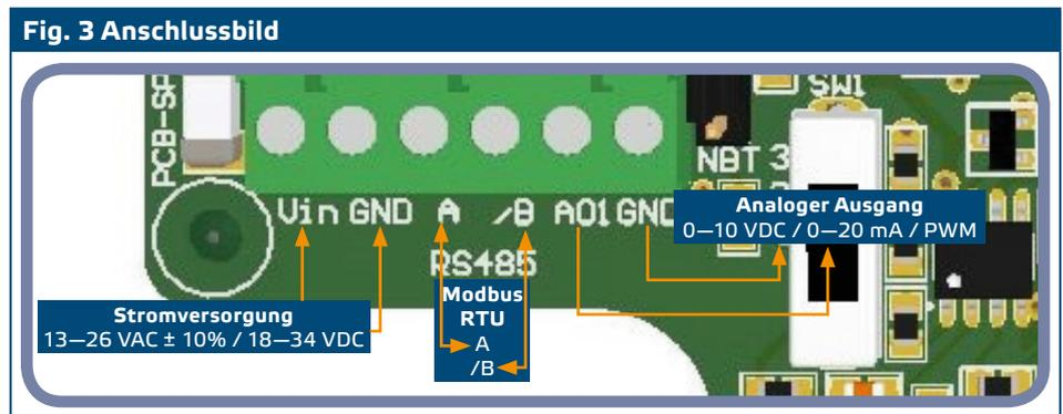
4. Wenn Ihr Gerät das Netzwerk startet oder beendet (siehe **Example 1** und **Example 2**) stellen Sie sich sicher, dass die NBT Steckbrücke auf den Pins gestellt ist wie angegeben in **Fig. 4** "Netzwerk Bus Terminator resistance Steckbrücke". In allen anderen Fällen soll die Steckbrücke nicht gestellt werden. NBT ist aktiv wenn die Steckbrücke gestellt wird (siehe **Examples 1 & 2** unten).
