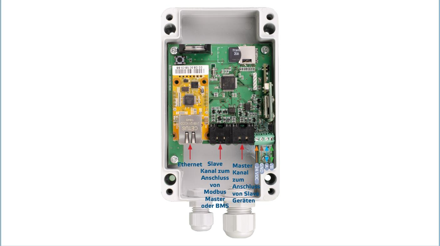
6. Wenn Sie sich für eine verkabelte Verbindung entscheiden, stecken Sie ein Standard Ethernet Kabel in den Ethernet Anschluss und verbinden Sie es mit dem Router.
