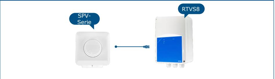
3. Um eine korrekte Kommunikation zu gewährleisten soll der NBT in nur zwei Geräten auf dem Modbus RTU Netzwerk aktiviert werden. Aktivieren Sie ggf. den NBT-Widerstand über 3SModbus oder Sensistant (*Holding Register 9*).
