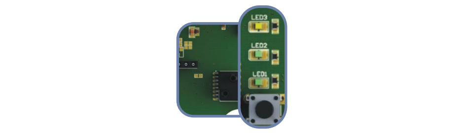
Fig. 7 Sensorkalibrierung und Modbus-Register-Reset-Taktschalter und Anzeige
