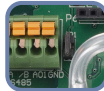
Fig. 5 Pullup-Widerstand Steckbrücke angeschlossen
