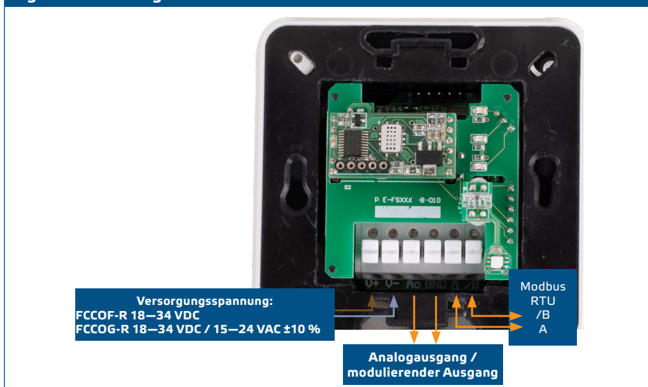
Fig. 1 Verkabelung und Anschlüsse
