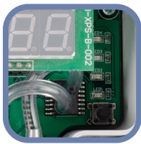
Fig. 8 Sensorkalibrierungsverfahren und Modbus-Register Reset Taktschalter und Anzeigen
