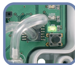
Fig. 16 Power / Modbus Kommunikationsanzeige
