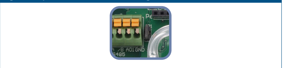
Fig. 5 Pullup-Widerstand Steckbrücke angeschlossen
