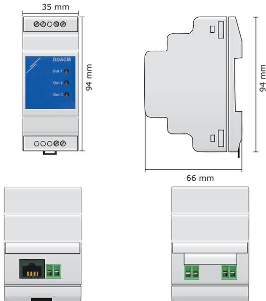
**Fig. 2 Einbaulage**
