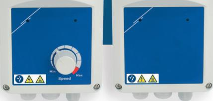
Die VFSC9 sind elektronische Drehzahlregler für einphasigen Induktionsmotoren (110–240 VAC / 50–60 Hz). Sie haben einen wählbaren analogen Eingang (0–10 VDC / 0–20 mA / PWM) und Modbus RTU Kommunikation. Im Vergleich zu Phasenanschnittsteuerung (TRIAC Drehzahlregler) generiert die VFSC9 Serie ein Ausgangssignal mit einer fast perfekten Sinusform, wohingegen die EMV Verschmutzung beschränkt bleibt. Der Leistungsfaktor überschreitet 95 %.
