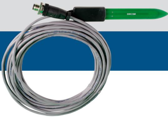
SWCSM-075 ist ein Bodenfeuchtesensor, der mit einem digitalen Temperatursensor ausgestattet ist. Es wird mit 24 VDC Power over Modbus versorgt. Die Messwerte und alle anderen Parameter sind über Modbus RTU zugänglich.
