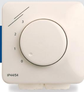
Der SMT-D-4P-EM ist ein Steuerschalter geeignet für EC Motoren. Er steuert die Geschwindigkeit über ein analoges 10 VDC Eingangssignal das in 3 Stufen umgesetzt wird entsprechend den relevanten Schalterstellungen. Zwei der Ausgangsspannungen können entsprechend den Umgebungsbedingungen angepasst werden (d.h. Schalterstellungen 1 und 2). Er hat ein spritzwassergeschütztes Gehäuse geeignet für Unterputz- und Aufputzmontage.
