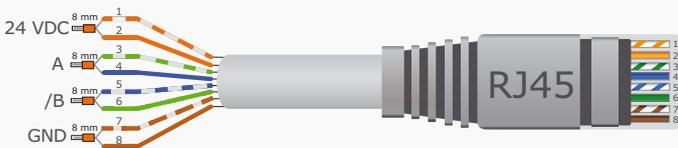
**Achtung!** Die Klemmleiste für den Anschluss der Ausgangsspannung (+24 V, GND) dupliziert den RJ45 Stecker (Parallelschaltung) Zur Berechnung der totalen Masse, fügen Sie beide Ladungen hinzu.
