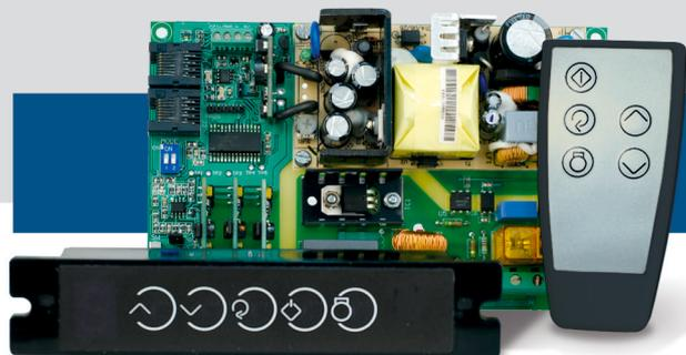
Der HFC ist eine moderne Regelung für Dunstabzugshauben. Es besteht aus einer PCH Netzplatine basiert auf Phasenregelung und HMIO5 optisches Touchpad um die Einstellungen der Steuerung zu ändern. Das Gerät kann mit einem zusätzlichen infrarot Fernbedienung ausgestattet werden - der RMT. Es kann auch Dunstabzugshauben regeln über 3SModbus Software. Der Regler verfügt über eine breite Palette von konfigurierbaren Steuerungsfunktionen.
