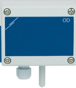
Die Produktreihe ODXT sind kombinierte Aussentempersensoren / -Schalter mit 4 vordefinierten und einem benutzerdefiniertem Bereich über Modbus. Sie verfügen über Modbus RTU (RS485) Kommunikation und haben einen Relaisausgang und einen Analogausgang / modulierenden Ausgang (0–10 VDC / 0–20 mA / PWM) Sie sind temperaturkompensiert und liefern ausgezeichnete langfristige Stabilität und erhöhte Leistung des Sensors / Schalters.
