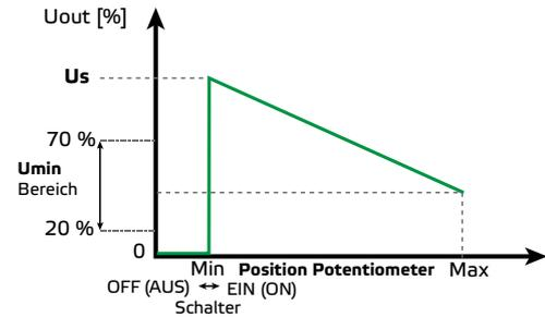
AUS (OFF) Stellung deaktiviert: Versorgungsspannung angeschlossen an L1 und N
