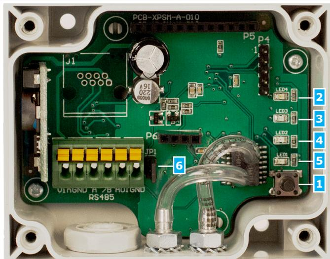
1 - Sensorkalibrierungsverfahren und Modbus-Register Reset Taktschalter (SW1)
