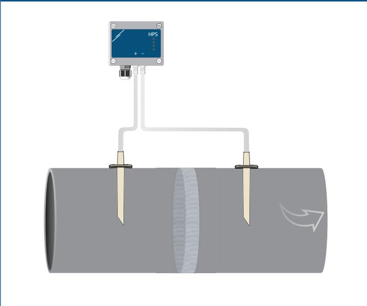
**Anwendung 2:** Messung der zugeführten Luftmenge [m<sup>3</sup>/h] oder der Luftgeschwindigkeit [m/s] mittels PSET-PT
