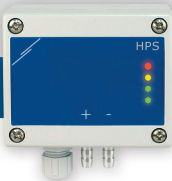
Die Produktreihe HPS-X--LP sind Differenzdruck-Transmitter (-125—125 Pa) die mit einem volligitalen Drucktransmitter für ein breites Anwendungsspektrum ausgestattet sind. Die Anzeige der Luftgeschwindigkeit ist durch Anschluss eines externen Pitot-Rohrverbindungssets möglich. Alle Parameter sind erreichbar über Modbus RTU (3S Modbus Software oder Sensistant). Sie verfügen außerdem über einen integrierten K-Faktor und einen Analogausgang /modulierenden Ausgang (0—10 VDC / 0—20 mA / 0—100 % PWM).
