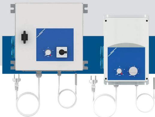
Die Traforegler GTT regeln die Drehzahl von einphasigen spannungsregelbaren Motoren durch Änderung der Ausgangsspannung gemäss einer gemessenen Temperatur. Sie sind ausgestattet mit Autotransformatoren und regeln die Lüfterdrehzahl in Automatikbetrieb oder Handbetrieb (in 5 Stufen) je nach dem Temperatureingang vom integrierten Kabelfühler. Bis 7,5 A sind die Regler erhältlich in einem Plastikgehäuse, über 7,5 A in einem Metallgehäuse.
