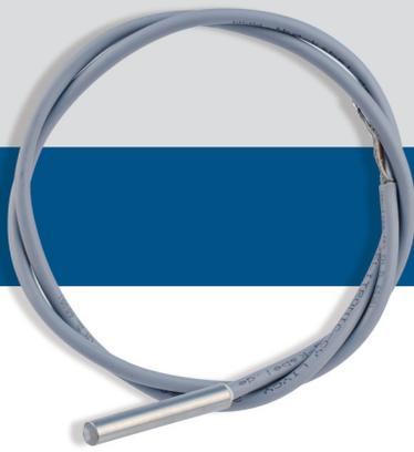
Die FSTSN-P500-010 passiven Temperatursonden mit geschirmtem Kabel verfügen über eine hervorragende Stabilität von Temperatureigenschaften dank dem Platinsensorelement. Das geschirmte Kabel wirkt als Faradaykäfig um Elektromagnetische Störungen und elektromagnetische Strahlung zu reduzieren. Das Sensorelement ist in Harz eingekapselt in einem Edelstahlrohr. Diese Temperatursensoren haben einen positiven Temperaturkoeffizienten des Widerstandes: wenn die Temperatur steigt, steigt der Widerstand.
