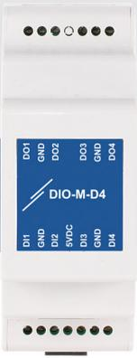
DIO-M-D4 ist ein Ein-/Ausgabemodul für Modbus-RTU-Netzwerke mit 4 digitalen Eingängen, 4 digitalen Ausgängen und Modbus-RTU-Kommunikation. Dieses Modul ermöglicht die Steuerung oder den Anschluss von Geräten ohne Modbus an ein Sentera Modbus RTU-Netzwerk.
