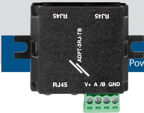
ADPT-3RJ-TB ist ein Adapter für Power over Modbus (PoM) Anschluss zwischen drei Standard UTP Netzwerken (RJ45) und einer 4-poligen Klemmleiste. PoM ist der Sentera Standard für die Verteilung von Modbus RTU (RS485) und Stromversorgung über einen einzigen RJ45 Anschluss. Der Adapter ADPT-3RJ-TB ermöglicht den Anschluss von Sentera Geräten mit PoM an Geräte mit normalen Klemmleisten.
