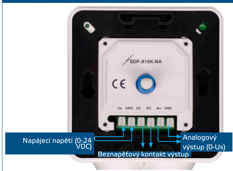
Obr. 1 Zapojení a připojení
