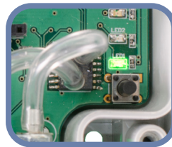
Obr. 7 Indikace napájení / komunikace Modbus
