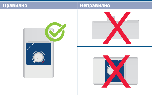
Фиг. 3 Положение за монтаж
