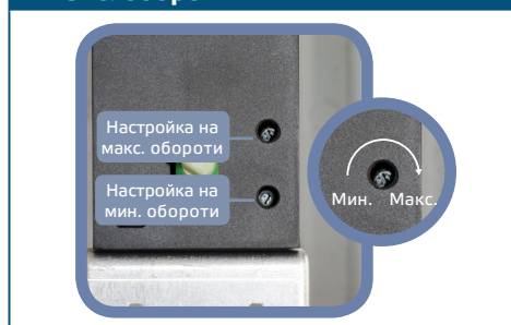
Фиг. 5 Тример за настройка на мин. и макс. обороти
