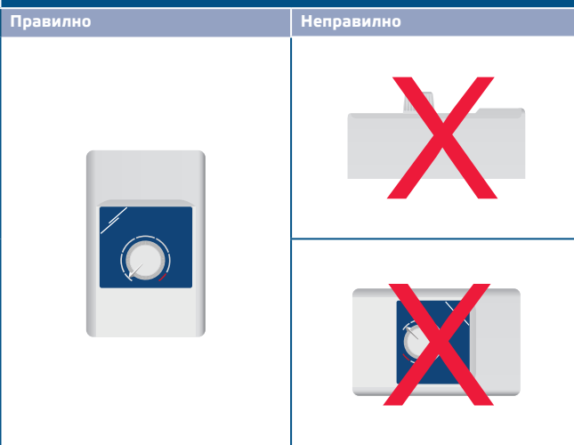
Фиг. 2 Положение за монтаж
