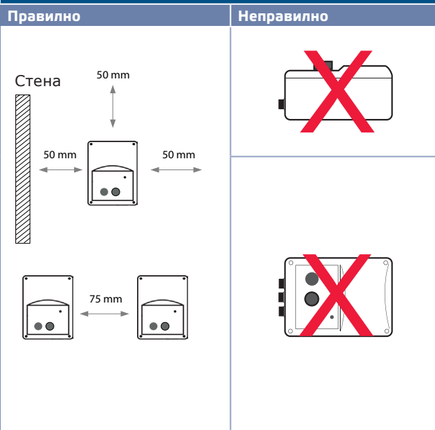
Фиг. 2 Положение за монтаж
