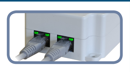
Фиг. 6. Индикация при налична Modbus комуникация
