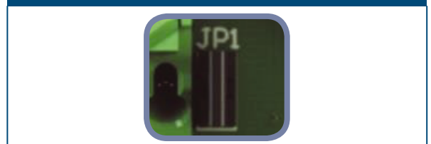
Фиг. 4 Джъмпер за съгласуващия резистор
