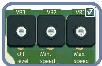
Фиг. 6 Триммер за настройка на макс. обороти
