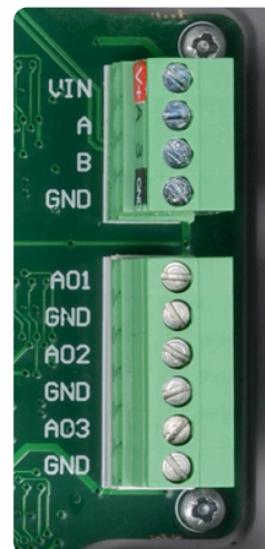
Фиг. 3 Окабеляване и свързване
