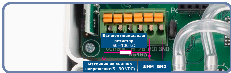
Фиг. 6 Пример за ШИМ (отворен колектор)
