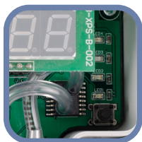
Фиг. 8 Бутон за стартиране на процедура за калибриране на датчика и възстановяване на фабричните Modbus настройки
