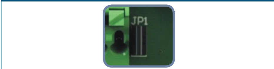
Фиг. 4 Джъмпер за съгласуващия резистор 1
