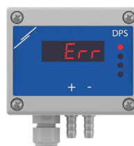
Фиг. 14 Повреда на сензорния елемент
